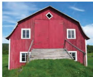
La variante du toit brisé à base recourbée est une adaptation pour éviter que l'eau coule sur les murs.
